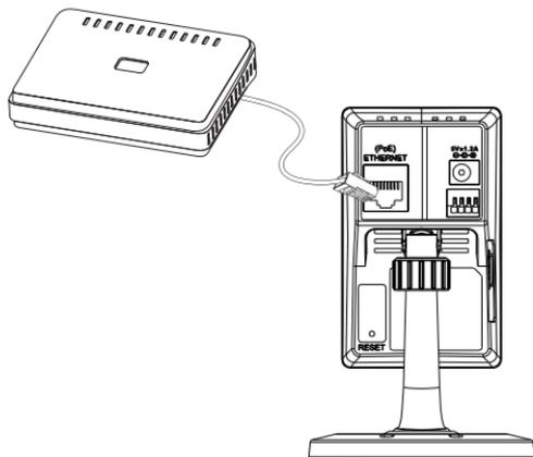
**Примечание:** Как только на устройство будет подаваться питание, индикатор загорится красным светом. Если устройство получило IP-адрес и станет доступным по сети, индикатор будет гореть зеленым светом.
