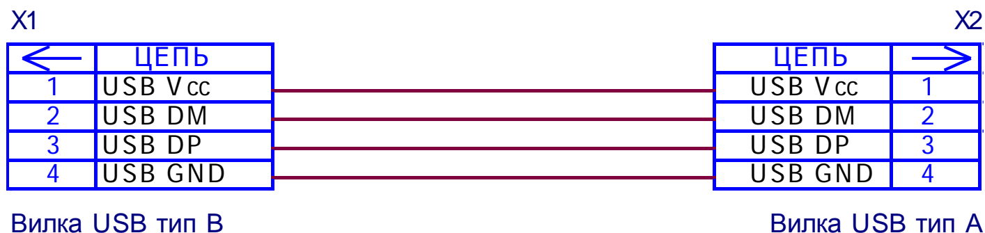
Рис. 5. Схема кабеля USB-AB
